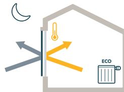
La **protección solar** de las ventanas se **cierra** para mantener el **calor en el interior**.
