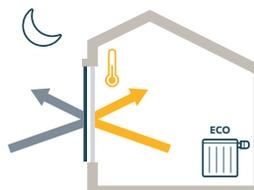
La **protección solar automatizada** de las ventanas se **abre** para calentar la casa de forma natural y se **cierra** para mantener el calor en el interior durante la noche.
